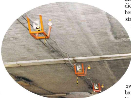
Messprismen und eine Schlauchwaage überwachen auch die geringsten Bewegungen des Baukörpers.
